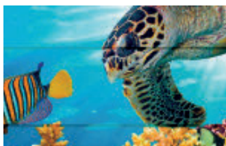
Sobreposição/Faixas escuras (Alimentação de mídia insuficiente)
