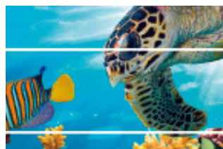
Intervalo / faixas brancas (quantidade excessiva de alimentação)
